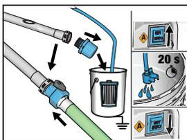
**4** Svitare la rete di protezione e metterla nel secchio dei rifiuti. Introdurre la valvola Power Flush nel tubo di aspirazione. Aprire la valvola Power Flush. Accendere l'interruttore di alimentazione e lasciare scorrere l'acqua attraverso il tubo di drenaggio per 20 secondi. Spegner l'interruttore di alimentazione.
