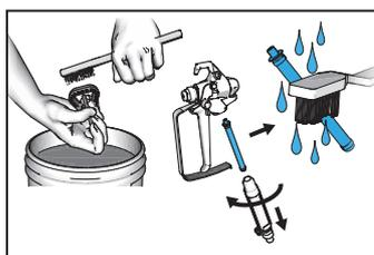
**7** Pulire con un pennello l'ugello di spruzzatura, la relativa protezione e la rete di protezione. Rimuovere il filtro della pistola e pulirlo. Rimontare il filtro della pistola, l'ugello di spruzzatura e la relativa protezione.
