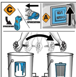
**5** Per risparmiare vernice all'interno del tubo, togliere la sicura del grilletto e azionare la pistola nel secchio della vernice, portare la valvola di adescamento/spruzzatura in posizione di **SPRUZZATURA** e accendere l'interruttore di alimentazione. Quando l'acqua esce dalla pistola, mantenere attivata la pistola e puntarla sul secchio dei rifiuti. Continuare a risciacquare fino a quando l'acqua si schiarisce.
