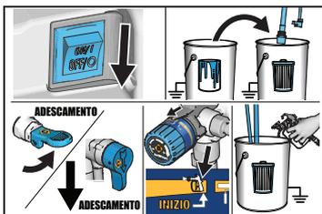
**1** Spegner l'interruttore di alimentazione. Mettere il tubo di aspirazione e il tubo di drenaggio nel secchio dei rifiuti. Portare la valvola di adescamento/spruzzatura su **ADESCAMENTO**. Ruotare la manopola di controllo della pressione nella posizione di **AVVIO**. Attivare la pistola in un secchio dei rifiuti.
