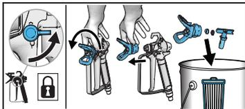
**2** Innescare la sicura del grilletto. Rimuovere l'unità di protezione dell'ugello dalla pistola e metterla nel secchio dei rifiuti.
