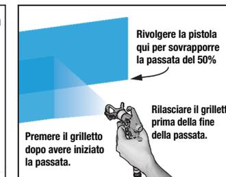
**2** Se necessario, aumentare la pressione attraverso la manopola fino a ottenere una spruzzatura uniforme e senza spazi vuoti ai bordi.
