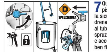
**7** Quando la vernice fuoriesce dalla pistola, rilasciare il grilletto. Innescare la sicura del grilletto. Trasferire il tubo di drenaggio nel secchio della vernice e fissarlo al tubo di aspirazione. Ruotare l'ugello di spruzzatura in posizione di SPRUZZATURA e accertarsi che la protezione dell'ugello sia ben fissata.
