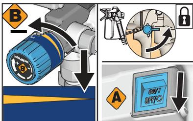
**6** Ruotare la manopola di controllo della pressione sull'impostazione minima e rilasciare il grilletto. Innescare la sicura del grilletto. Spostare la valvola di adescamento/spruzzatura su **ADESCAMENTO** e spegnere l'interruttore di alimentazione.
