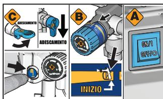
**3** Portare la valvola di adescamento/spruzzatura nella posizione PRIME (adescamento). Premere due volte il pulsante PushPrime per allentare la sfera di ingresso.\* Ruotare la manopola di controllo della pressione nella posizione di AVVIO. Accendere l'interruttore di alimentazione.
