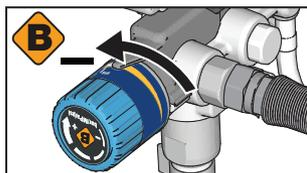
**3** Ruotare la manopola di regolazione della pressione sull'impostazione minima.
