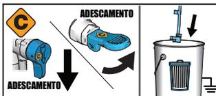
**2** Portare la valvola di adescamento/spruzzatura su **ADESCAMENTO**. Collocare il tubo di drenaggio nel secchio dei rifiuti. Ruotare la manopola di controllo della pressione nella posizione di **AVVIO**.
