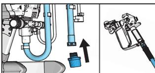
**5** Avvitare nuovamente la rete di protezione al tubo di aspirazione. Assicurarsi che la pistola a spruzzo e il flessibile siano collegati saldamente allo spruzzatore.
