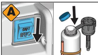
**4** Quando il Pump Armor viene pulito con lo spruzzatore, spegnere l'interruttore di alimentazione. Sostituire e stringere il cappuccio per facilitare la conservazione, rendendolo sicuro per i bambini.
