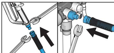
**1** Se necessario, collegare il flessibile alla pistola. Rimuovere il cappuccio rosso, quindi collegare il flessibile allo spruzzatore. Serrare saldamente.
