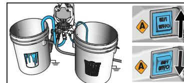
**5** Immergere il tubo di aspirazione nella vernice. Accendere l'interruttore di alimentazione e fare attenzione alla fuoriuscita della vernice dal tubo di drenaggio. Spegnere l'interruttore di alimentazione.
