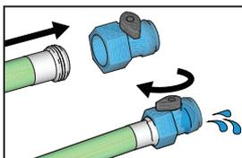
**3** Avvitare la valvola Power Flush (acclusa con lo spruzzatore) in un tubo flessibile da giardino. Aprire l'acqua. Aprire la valvola Power Flush. Sciacquare via la vernice dai tubi di drenaggio e di aspirazione, da rete di protezione e ugello di spruzzatura e dalla protezione dell'ugello. Chiudere la valvola Power Flush.
