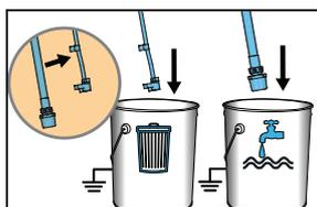
**2** Separare il tubo di drenaggio (più piccolo) dal tubo di aspirazione (più grande). Collocare il tubo di drenaggio in un secchio dei rifiuti. Immergere il tubo di aspirazione in un secchio riempito con acqua per quanto riguarda materiali a base di acqua, oppure con acqua ragia in caso la spruzzatura avvenga su materiale a base di olio.
