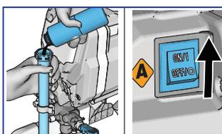
**3** Sostenendo il tubo di aspirazione al di sopra dello spruzzatore, versare circa 60 ml (2 once) di Pump Armor nel tubo di aspirazione e accendere l'interruttore di alimentazione.
