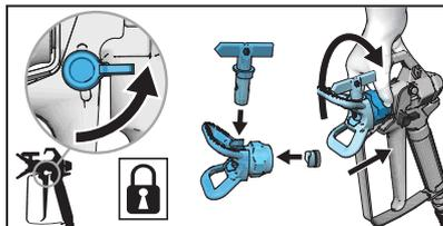
**2** Innescare la sicura del grilletto. Accertarsi che l'ugello sia inserito correttamente nella relativa protezione e che l'unità di protezione dell'ugello sia fissata saldamente alla pistola.
