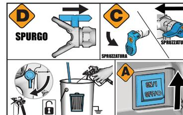
**6** Ruotare l'ugello di spruzzatura in posizione di SPURGO. Togliere la sicura del grilletto. Dirigere la pistola verso il secchio dei rifiuti, quindi premere il grilletto e tenerlo saldamente. Portare la valvola di adescamento/spruzzatura su SPRUZZATURA e accendere l'interruttore di alimentazione.
