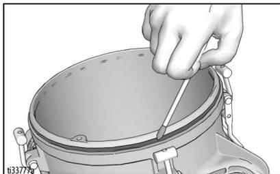
7. **Apenas para a pistola de pintura por pressão:** Se a tampa estiver demasiado solta e haja fuga de ar quando pressurizada, ajuste os quatro ganchos da tampa para a apertar.
