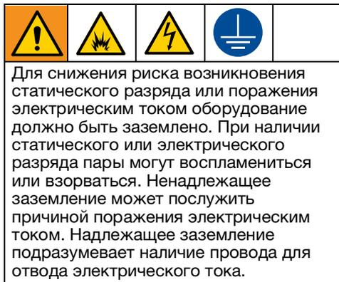
Это оборудование оснащено проводом заземления и надлежащей заземляющей вилкой. Вилка сетевого шнура должна вставляться в розетку, которая установлена и заземлена должным образом в соответствии со всеми местными правилами и предписаниями.
