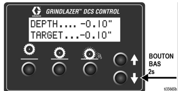
\*L'interrupteur du guidon à bascule contrôle les mêmes éléments que les boutons fléchés Haut et Bas.
