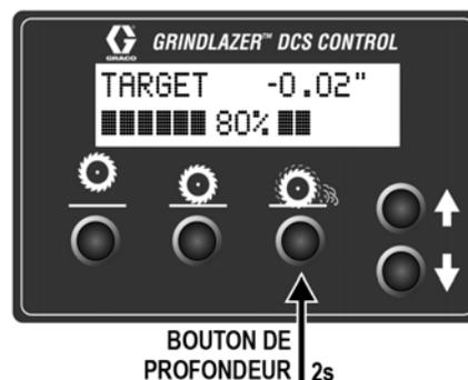
La commande de structure de commande dynamique est désormais prête à rainurer/scarifier. Appuyez longtemps sur l'interrupteur de guidon à bascule pour abaisser le tambour à la hauteur de découpe souhaitée. Appuyez rapidement sur les commandes Haut ou Bas de l'interrupteur pour ajuster votre hauteur de découpe à la volée. Lorsque vous avez terminé avec votre découpe, appuyez longuement sur le bouton Haut de l'interrupteur pour remettre le tambour en position de début.
