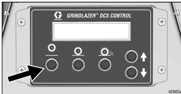
6. **Modèle 25M994 uniquement** : Assurez-vous que l'interrupteur d'alimentation (B) est en position haute.
