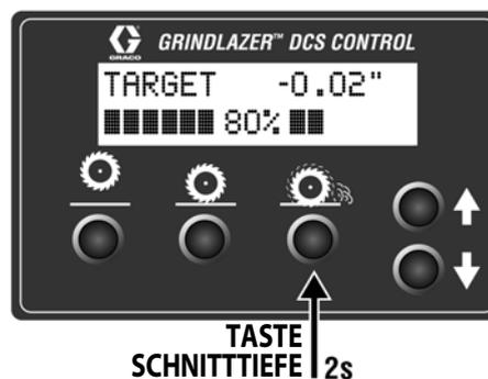
Die DCS-Steuerung ist jetzt bereit zum Fräsen/Entfernen von Linien. Halten Sie den Wippschalter am Handgriff gedrückt, um die Trommel auf Ihre Soll-Schnitttiefe abzusenken. Drücken Sie den Schalter kurz nach oben oder unten, um Ihre Schnitttiefe im laufenden Betrieb anzupassen. Wenn Sie mit dem Schneiden fertig sind, drücken Sie den Schalter lange nach oben, um die Trommel in die Ausgangsposition zu bringen.
