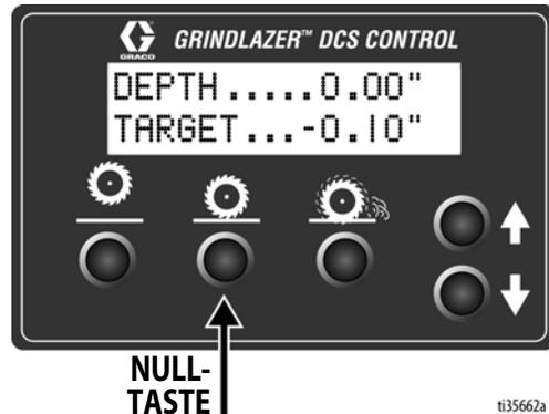
**Langes Drücken:** Der Nullpunkt zur aktuellen Trommelposition wird neu programmiert.
