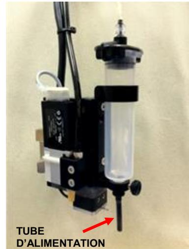
3. Glissez le tube d'alimentation sur l'extrémité avec barbillon de la plaque de buse.
