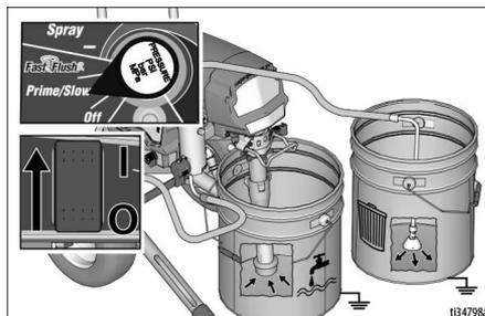
7. Ruotare la manopola di regolazione della pressione su **OFF** (in senso antiorario fino in fondo).
