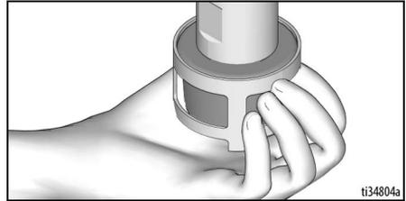
4. Riempire il dado della guarnizione del pistone con TSL™ Graco per prevenire l'usura prematura delle guarnizioni. Eseguire quest'operazione ogni volta che si spruzza.
