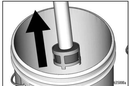
13. Azionare la pistola a spruzzo verso il secchio di lavaggio, quindi ruotare la manopola di controllo della pressione sulla posizione ore 12, per scaricare il fluido dal flessibile.
