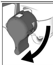
6. Per avviare il motore, ruotare il dispositivo di controllo della pressione sulla posizione **Adescamento/lento** e portare l'interruttore **ON/OFF** sulla posizione **ON**. Il fluido di lavaggio scorrerà nel tubo di aspirazione e fuoriuscirà dal tubo di scarico nel secchio dei rifiuti. Lasciare che il fluido di lavaggio fuoriesca dal tubo di scarico per 5 secondi.
