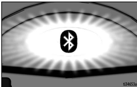
Il conteggio totale dei lampeggiamenti del LED equivale al codice di errore (ad esempio: due lampeggi equivale al CODICE 02).
