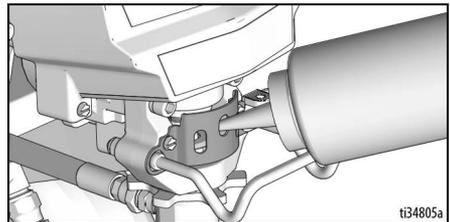
5. Accertarsi che l'ugello sia inserito correttamente nella relativa protezione e che l'unità di protezione dell'ugello sia fissata saldamente alla pistola a spruzzo. Fare riferimento al manuale separato della pistola a spruzzo.
