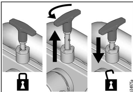
3. Tirare l'impugnatura della bobina verso il basso e verso l'esterno. Ruotare in senso orario per avvolgere il flessibile.
