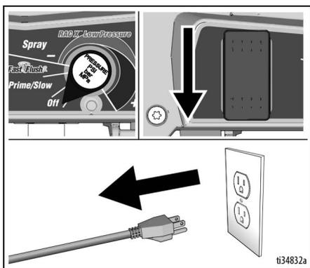
16. Abbassare la Valvola di adescamento/spruzzatura nella posizione di **ADESCAMENTO**.
