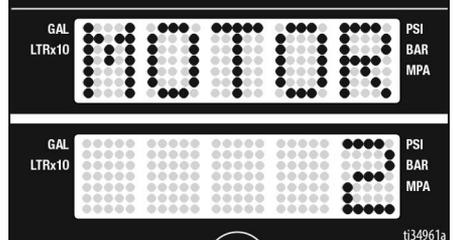
5. Premere rapidamente il pulsante **DISPLAY**. **LAST CODE** (Ultimo codice) scorre sullo schermo e viene visualizzato l'ultimo codice, es. **CODE 06 MOTOR THERMAL PROTECTION ENABLED** (Codice 06 Protezione termica motore abilitata) (vedere il manuale di riparazione).
