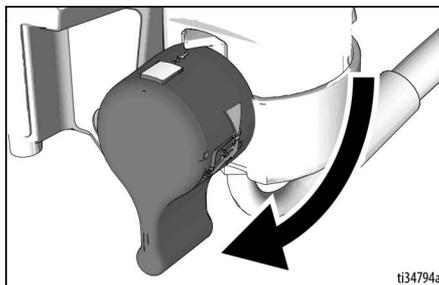
5. Mantenere fermamente la pistola a spruzzo rivolta verso un secchio collegato alla messa a terra. Puntare la pistola a spruzzo verso un secchio. Togliere la sicura del grilletto e premere il grilletto della pistola a spruzzo per scaricare la pressione.
