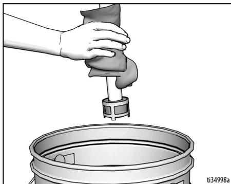
4. Collocare il tubo di aspirazione nel fluido di lavaggio appropriato. Collocare il tubo di scarico nel secchio dei rifiuti.
