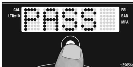
**NOTA:** Se la manopola non è correttamente allineata, viene visualizzato **FAIL**, quindi di nuovo **KNOB** (Manopola). Assicurarsi che la manopola di controllo della pressione sia correttamente allineata, quindi ripetere la procedura di calibrazione.
