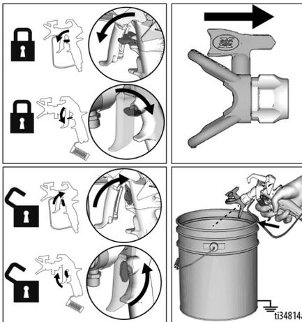
**NOTA:** Se l'ugello risulta difficile da ruotare quando si esegue la rotazione verso la posizione di SPURGO, eseguire la **Procedura di scarico della pressione**, pagina 18, quindi ruotare la valvola di adescamento/spruzzatura in posizione di SPRUZZATURA e ripetere il passaggio 1.
