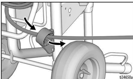
2. Sollevare e ruotare il blocco del perno di 90° per sbloccare la bobina del flessibile. Tirare il flessibile per rimuoverlo dalla relativa bobina.
