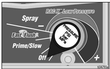
4. Inserire il tubo di drenaggio in un secchio dei rifiuti e ruotare la valvola di adescamento/spruzzatura verso il basso in posizione **ADESCAMENTO** per scaricare la pressione.
