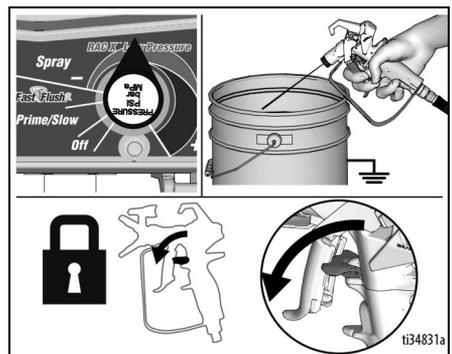
15. Ruotare la manopola di controllo della pressione su OFF e ruotare l'interruttore ON/OFF in posizione **OFF**. Scollegare l'alimentazione dello spruzzatore.
