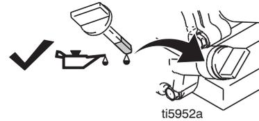
6. Laisser le moteur se refroidir. Retirer le bouchon du réservoir et le remplir. Serrer fermement le bouchon.
