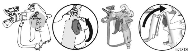
8. Segure a pistola contra o balde de lavagem de metal ligado à terra. Acione a pistola e aumente lentamente a pressão do líquido, até a bomba funcionar com suavidade.
