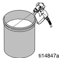
7. Vire a válvula de ferrar para baixo, para a posição DRENAR e deixe que o líquido de lavagem circule até aparecer transparente.
