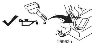
6. Deixe que o motor arrefeça. Retire a tampa e encha o depósito de combustível. Feche firmemente a tampa.
