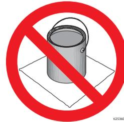
**Ligue sempre o balde metálico à terra:** ligue o fio de terra ao balde. Fixe uma extremidade ao balde e a outra a uma ligação efetiva à terra, tal como um tubo de água.
