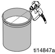
9. Den Saugschlauch aus der Spülflüssigkeit heben und das Spritzgerät ca. 15 bis 30 Sekunden laufen lassen, um die gesamte Flüssigkeit aus dem Gerät zu entfernen. Den Pumpenschalter auf OFF stellen und den Motor ausschalten
