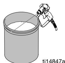
7. Das Entlüftungsventil nach unten auf die DRAIN-Position drehen und die Spülflüssigkeit zirkulieren lassen, bis sie klar aussieht.
