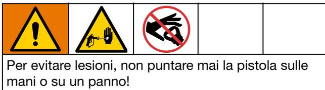
1. Rilasciare il grilletto e innescare la sicura. Ruotare l'ugello reversibile. Disinserire la sicura del grilletto. Premere il grilletto per liberare l'ostruzione.
