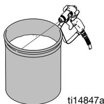
7. Ruotare la valvola di adescamento sulla posizione di SCARICO e permettere al fluido di lavaggio di circolare fino a che il fluido stesso non diventa pulito.
