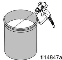
7. 将填料阀旋转至泄流位置以循环冲洗流体，直到出现洁净的冲洗流体。
