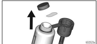
3. En caso de que sea necesario, desenrosque la rejilla de entrada del tubo de aspiración. Coloque la válvula de cebado/pulverización en la posición PRIME (Cebado).
