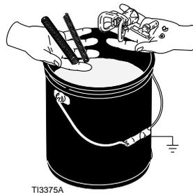
16. Заполните насос защитным раствором Pump Armor и соберите в обратном порядке фильтр, соплодержатель и сопло.
