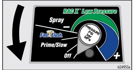
4. Ablassrohr in einen Abfalleimer halten und Ansaugventil in ANSAUGEN-Position drehen, um Druck abzulassen. Das Ansaugventil solange in der unteren Position (Ablassposition) stehen lassen, bis die Spritzarbeiten wieder aufgenommen werden sollen.
