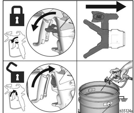
2. Die Abzugssperre verriegeln. Die Spritzdüse wieder in die ursprüngliche Stellung bringen. Entriegeln Sie die Abzugssperre und fahren Sie mit dem Spritzen fort.
