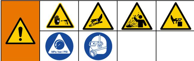
本装置は、圧力が手動で開放されるまでは、加圧状態が続きます。加圧された液体（肌への噴射など）、液体の飛散、可動部品による深刻な負傷の発生を防止するため、スプレー停止後と装置を清掃、点検、および整備する前に、圧力開放手順に従ってください。
