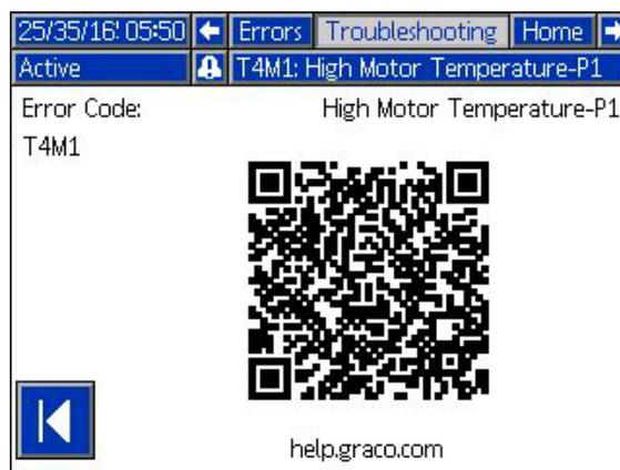
Существует три вида ошибок, которые могут возникнуть. Ошибки отображаются на дисплее, а также на сигнальной башне (дополнительно).
