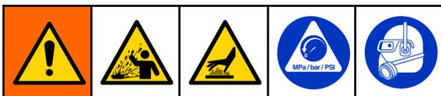
Cet équipement reste sous pression tant que la pression n'a pas été relâchée manuellement. Pour éviter des blessures graves provoquées par du fluide sous pression, comme des éclaboussures, suivre la Procédure de décompression lorsque l'on arrête la pulvérisation et avant un nettoyage, une vérification ou un entretien de l'équipement.
