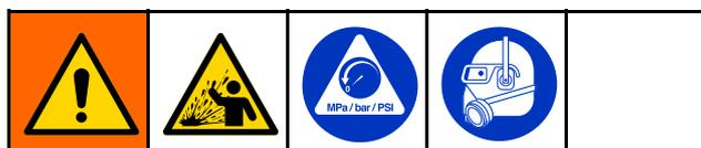
Este equipamento permanece pressurizado até que a pressão seja aliviada manualmente. Para ajudar a evitar ferimentos graves devidos ao líquido pressurizado, como salpicos para os olhos ou a pele, siga o Procedimento de Descompressão quando parar de bombear e antes de limpar, verificar ou reparar o equipamento.
