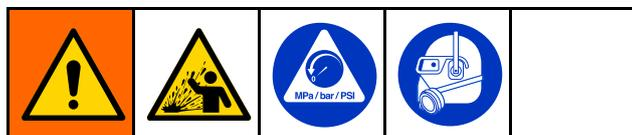
Este equipo permanece presurizado hasta que se libere manualmente la presión. Para ayudar a evitar lesiones graves por fluido presurizado, como salpicaduras de fluido en la piel o en los ojos, siga el Procedimiento de descompresión cuando deje de bombear y antes de limpiar, revisar o reparar el equipo.
