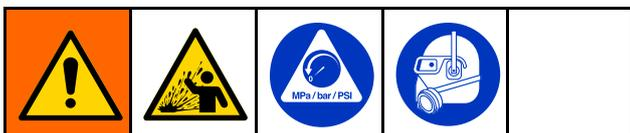
L'apparecchiatura rimane pressurizzata finché la pressione non viene scaricata manualmente. Per evitare gravi lesioni causate dal fluido pressurizzato, ad esempio spruzzi negli occhi o sulla pelle, seguire la procedura di scarico della pressione quando si smette di pompare e prima di pulire, verificare o eseguire la manutenzione dell'apparecchiatura.
