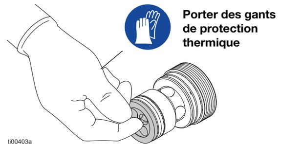
**FIG. 85 : Contrôler la buse d'installation du siège**
