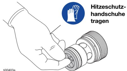
ABB. 85: Tipp zur Installation des Rückschlagsitzes
