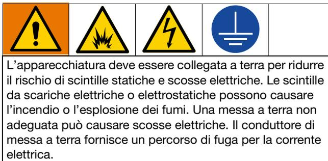
**Sistema di erogazione a caldo:** Il sistema è munito di un terminale di terra. Un elettricista qualificato deve collegare a terra il sistema utilizzando questo terminale. Vedere **Collegamento del cavo elettrico** a pagina 18.
