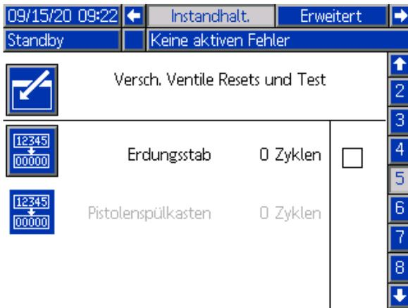
**Erdungsstab:** Aktiviert den Erdungsstab (hebt ihn an), damit das System eine Ladung aufbauen kann. Verwenden Sie diese Option, um die Wartung des Erdungsstabs durchzuführen. Siehe die einzelnen Schritte im Kapitel [Überprüfen und Schmieren des Erdungsstabs](#), page 69.
