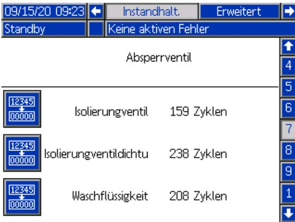
**Isolierungsventil:** Überwacht jede Betätigung des Absperr- bzw. Isolierungsventils.
