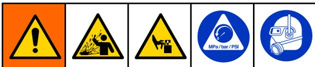
Dieses Gerät bleibt unter Druck, bis der Druck manuell entlastet wird. Zur Vermeidung schwerer Verletzungen durch Material unter Druck wie z. B. Spritzer in die Augen oder auf die Haut immer die **Druckentlastung** durchführen, wenn mit dem Spritzen aufgehört wird sowie vor Reinigung, Inspektion oder Servicearbeiten am Gerät.
