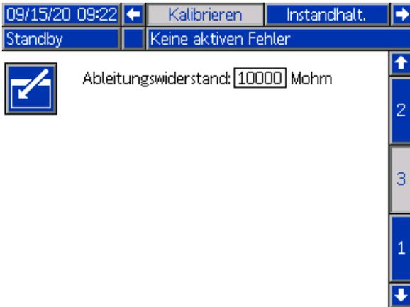
**Ableitungswiderstand:** Der Widerstand, der zur langsamen Entladung des Systems verwendet wird und eine Verbindung zur Erde herstellt, wenn das System geladen ist.
