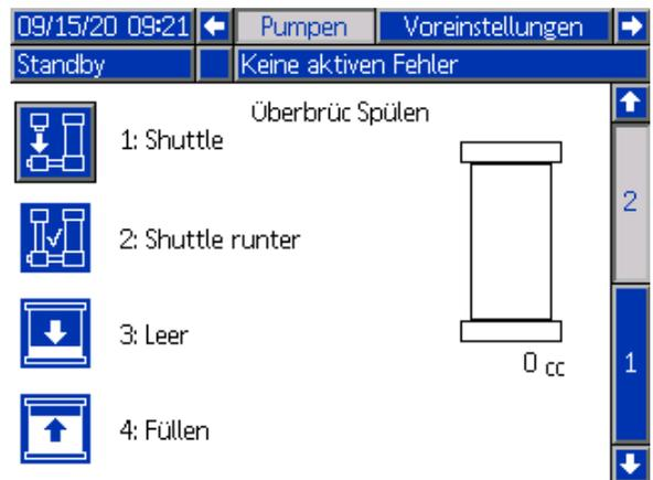
Öffnen Sie den Schrank und gehen Sie wie in diesem Bildschirm vorgegeben vor, um die Pumpe manuell zu entleeren und wieder zu befüllen.
