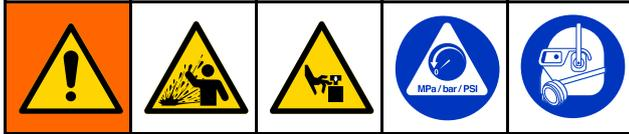
L'apparecchiatura rimane pressurizzata finché la pressione non viene rilasciata manualmente. Per evitare lesioni serie causate dal fluido pressurizzato, ad esempio schizzi negli occhi o sulla pelle, o dalle parti mobili, seguire la **procedura di scarico della pressione** quando si termina la spruzzatura e prima di pulire, controllare o sottoporre a manutenzione l'apparecchiatura.
