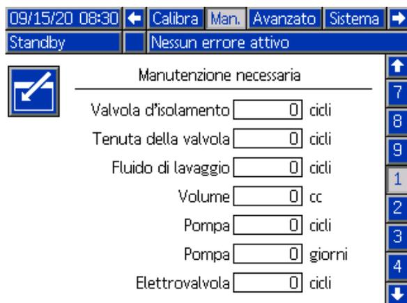
**Valvola d'isolamento:** Il numero di volte in cui la navetta della valvola d'isolamento si è mossa.
