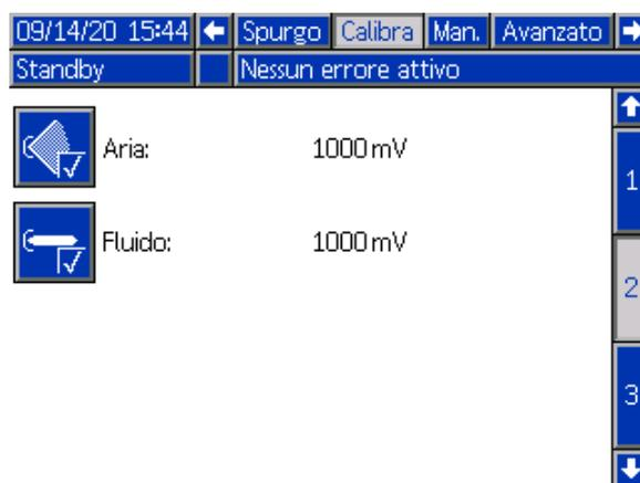
**Aria:** Pressione attuale dell'aria in millivolt (mV) a fini di calibrazione.
