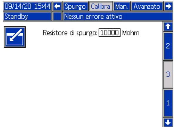
**Resistore di spurgo:** Il resistore utilizzato per scaricare lentamente il sistema, fornendo un percorso verso massa quando il sistema è carico.
