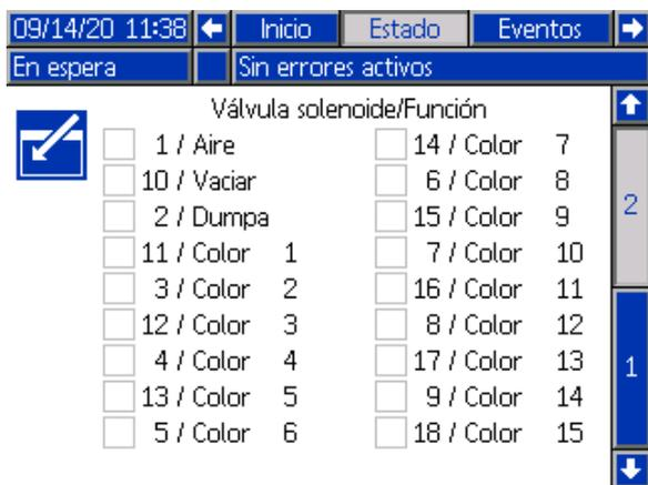
La pantalla muestra el número de válvula solenoide y la función de la válvula. Una casilla marcada indica que la solenoide está activada.
