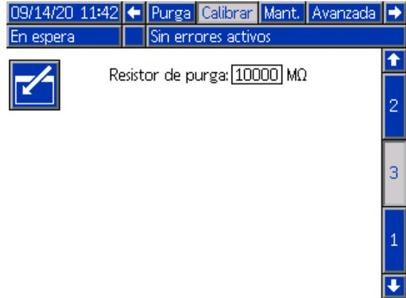
**Resistor de purga:** resistor que se emplea para descargar lentamente el sistema y que proporciona una ruta a tierra cuando el sistema está cargado.
