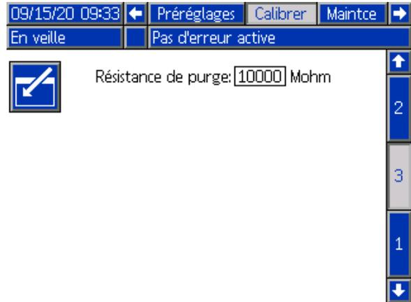
**Résistance de purge :** résistance utilisée pour décharger lentement le système et qui permet une mise à la terre lorsque le système est chargé.
