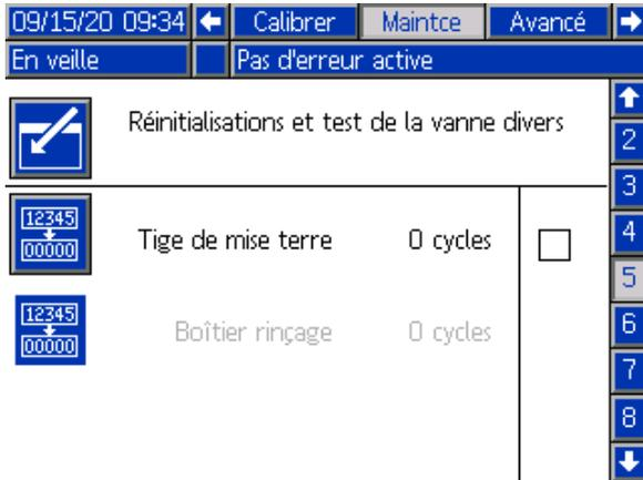
**Tige de mise terre** : active (soulève) la tige de mise à la terre pour que le système accumule la charge. Utilisez cette option pour réaliser la maintenance de la tige de mise à la terre. Reportez-vous aux étapes de la section [Vérification et lubrification de la tige de mise à la terre](#), page 71.
