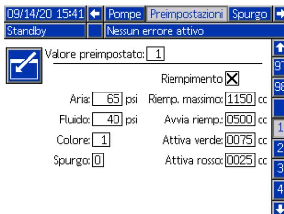
**Valore preimpostato:** Il numero assegnato a questo set di parametri di spruzzatura, colore della vernice e sequenza di spurgo.
