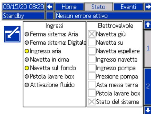
Figure 35 Posizione del sensore della valvola di isolamento nel menu Stato
