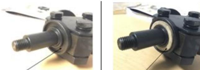
2. Deslice el conjunto de la cortadora sobre el eje hasta la placa de respaldo.
