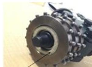
4. Deslice la cubierta exterior del cojinete sobre el eje contra la arandela de fieltro.
