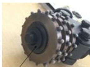
6. Coloque la tuerca hexagonal en el eje. Apriete de manera que la tuerca quede apretada pero las cortadoras puedan girar libremente sobre sus cojinetes (si no hay rotación, la tuerca está demasiado apretada).
