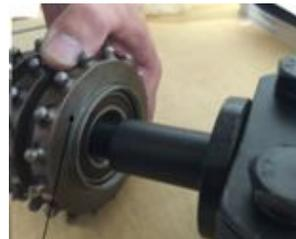
3. Deslice la arandela de fieltro sobre el eje dentro del espacio entre el borde de la cortadora y el borde del cojinete.
