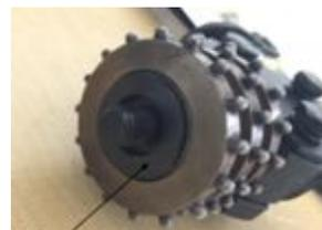
5. Deslice la arandela Belleville sobre el eje contra la cubierta exterior del cojinete.
