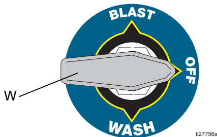
ABB. 1: Das Wahlventil auf Off (Aus) stellen
