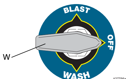
FIG. 1: Ruotare la valvola del selettore su OFF
