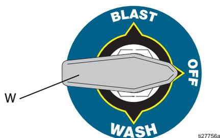
**Рис. 1: Перевод селекторного клапана в положение OFF (Отключено)**
