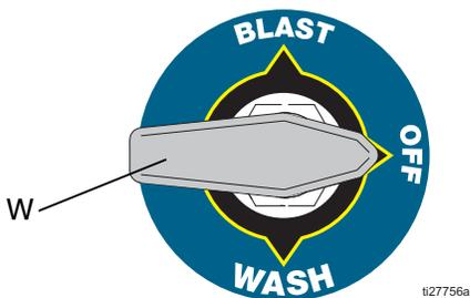
FIG. 1: Girar la válvula selectora a OFF
