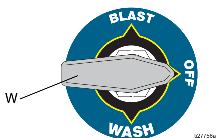
FIG. 1: Vrid omkopplingsventilen till från
