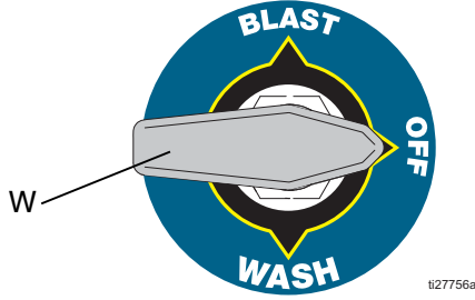
ŞEKİL 1: Seçici valfini kapalı (OFF) konumuna getirin
