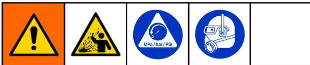
Per ridurre il pericolo di lesioni, seguire la Procedura di scarico della pressione prima di controllare qualunque parte del sistema o di effettuarne la manutenzione e quando viene richiesto di scaricare la pressione.
