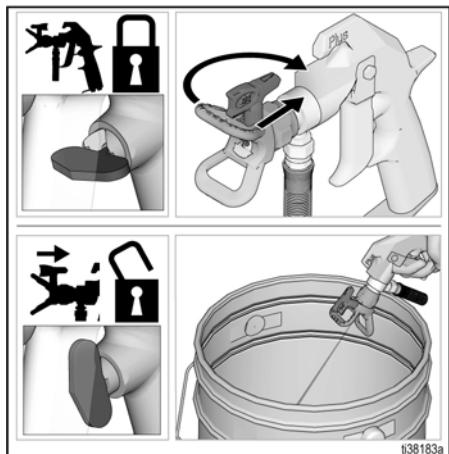
2. Aktivirajte blokadu otponca. Okrenite mlaznicu za raspršivanje natrag u položaj za RASPRŠIVANJE Deaktivirajte blokadu otponca i nastavite s raspršivanjem.
