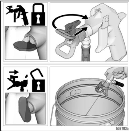
2. Engate o fecho do gatilho. Rode o bico de pulverização para a posição PULVERIZAR. Desengate o fecho do gatilho e continue a pintar.
