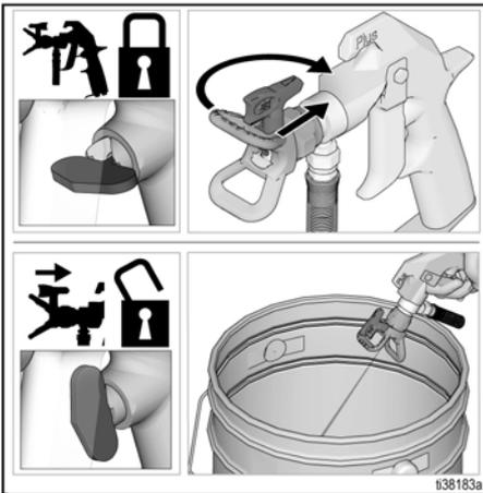
2. 锁上扳机锁。将喷嘴回旋至“喷涂”位置。松开扳机锁，继续喷涂。
