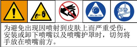
为避免出现因喷射到皮肤上而严重受伤，安装或卸下喷嘴以及喷嘴护罩时，切勿将手放在喷嘴前方。
