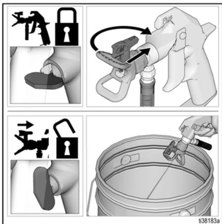
2. Aktivirajte blokadu otkopca. Okrenite mlaznicu za raspršivanje natrag u položaj za RASPRŠIVANJE. Deaktivirajte blokadu otkopca i nastavite s raspršivanjem.
