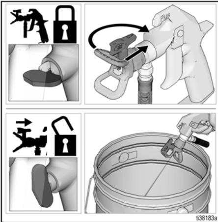
2. Sett på avtrekkerlåsen. Drei dysen tilbake i SPRØYTE-posisjon. Ta av avtrekkerlåsen og forsett å sprøyte.
