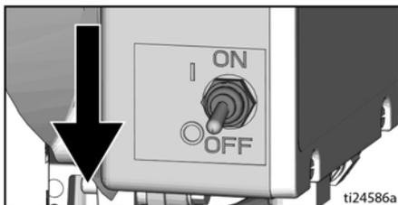
2. Ative o bloqueio do gatilho da pistola. Sempre ative o bloqueio do gatilho quando o pulverizador for desligado para impedir que a pistola seja disparada acidentalmente.
