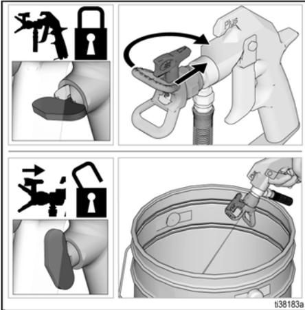
2. Ative o fecho do gatilho. Gire a ponta de pulverização de volta para a posição PULVERIZAÇÃO. Desative o fecho do gatilho e continue pulverizando.
