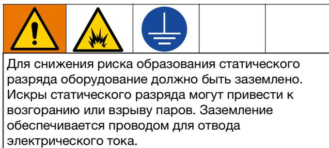
Ниже приведены минимальные требования к заземлению для базовой установки пистолета Switch 3D. Используемые система и робот могут включать другое оборудование и элементы, требующие заземления. Подробные инструкции по заземлению см. в местных правилах и нормах.
