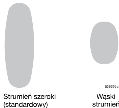
Rys. 21: Szerokości natrykiwanego strumienia
