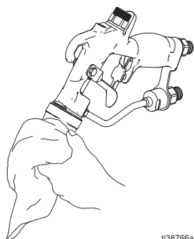
Rys. 39: Oczyścić zewnętrzne powierzchnie pistoletu
