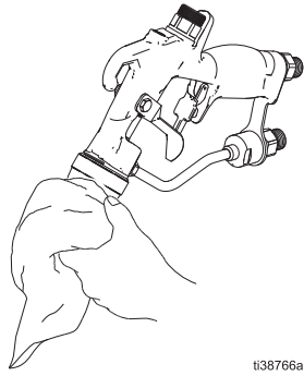
Рис. 39: Очистите внешнюю поверхность краскораспылителя
