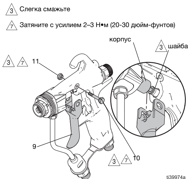
Рис. 44: Установка курка
