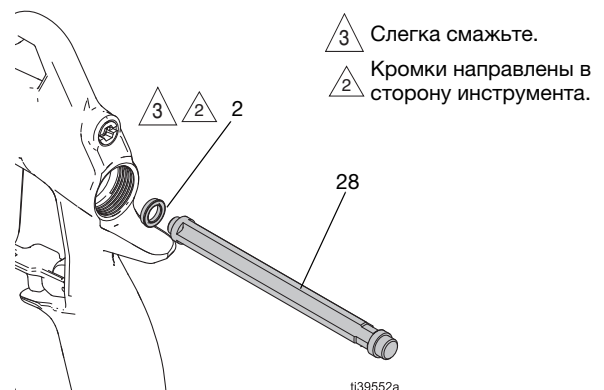
Рис. 47: Установка U-образного уплотнения
