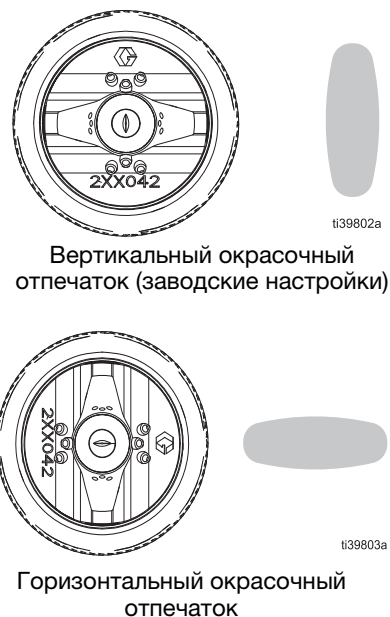
Рис. 9: Положения окрасочного факела
