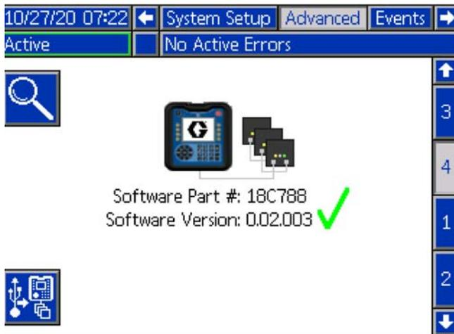
Auf diesem Bildschirm kann die Software-Version angezeigt werden, die im System verwendet wird. Zusätzlich wird dieser Bildschirm verwendet, um die Systemsoftware über ein USB-Laufwerk mit der neuesten Software und einem schwarzen Graco Token zu aktualisieren. Die neueste Software wird auf [Help.graco.com](http://Help.graco.com) bereitgestellt. Siehe Handbuch ADM-Token In-System-Programmierung für eine detaillierte Beschreibung dieses Bildschirms. Siehe **Sachverwandte Handbücher** auf Seite 3.
