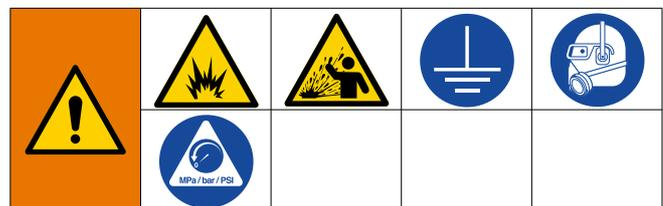
Um Brände und Explosionen zu vermeiden, Gerät und Müllcontainer immer erden. Um statische Funkenbildung und Verletzungen durch Spritzer zu vermeiden, immer mit dem kleinstmöglichen Druck spülen.
