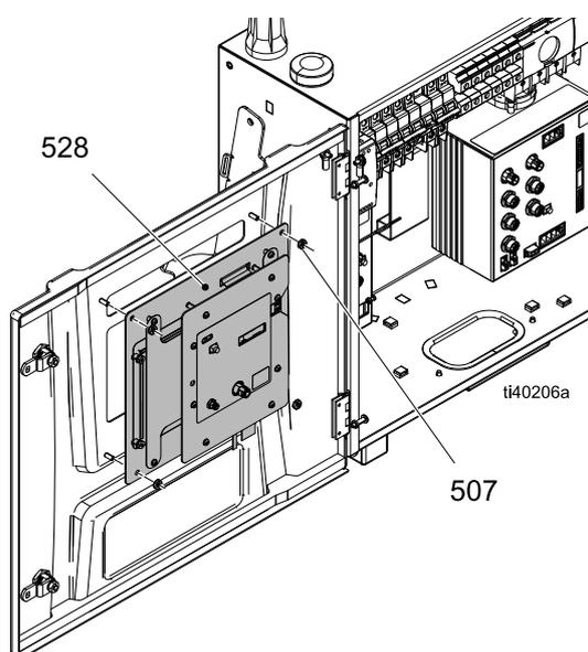
5. Raccorder le câble CAN et le câble cellulaire. Voir **Schémas électriques**, page 69.
