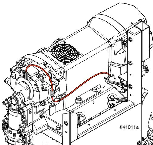
3. Placer la plaque du moteur sur le châssis (1) et visser partiellement à la main tous les boulons (22). Une fois que tous les boulons sont amorcés et que la plaque du moteur est alignée, serrer les boulons (22).
