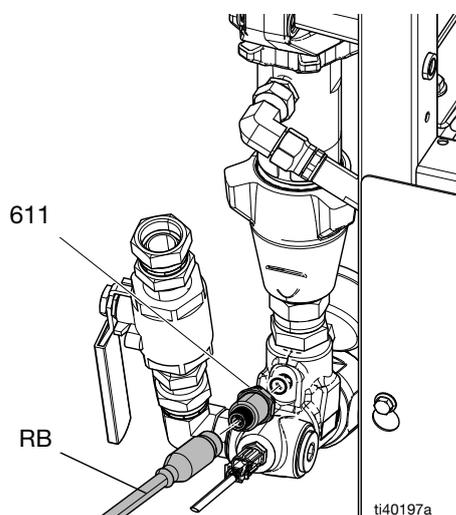
4. Remplacer le câble du capteur de pression d'entrée :
