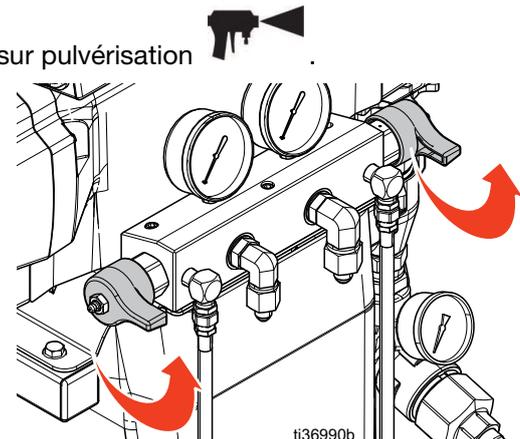
6. Maintenir le collecteur de fluide du pistolet au-dessus de deux conteneurs à déchets mis à la terre. Ouvrir les vannes de fluide XA et XB (voir page 15) jusqu'à ce que seul du solvant s'écoule des vannes. Fermer les vannes. Le flexible et le collecteur de pistolet du Reactor sont maintenant rincés.
