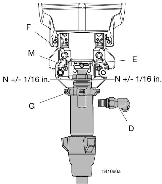
2. Continuer à visser la pompe dans le boîtier jusqu'à ce que la sortie de fluide (D) soit en face du flexible en acier et que les filetages supérieurs soient à +/- 2 mm (1/16 po.) de la face des roulements (N).
