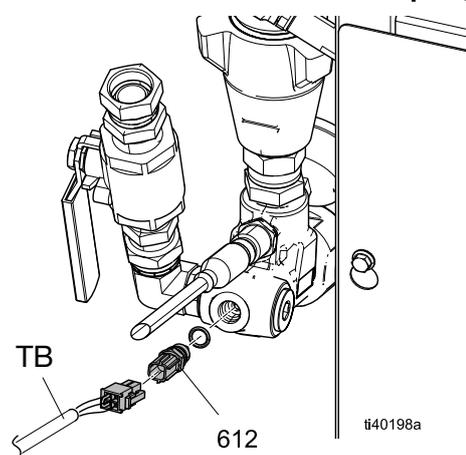
4. Remplacer le câble du capteur de température d'entrée :
