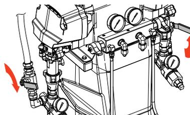
10. Régler les vannes de décompression/pulvérisation (SA, SB) sur
