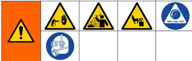
Cet équipement reste sous pression tant que la pression n'a pas été relâchée manuellement. Pour éviter de sérieuses blessures provoquées par du fluide sous pression, comme des injections cutanées, des éclaboussures de fluide et des pièces en mouvement, suivre la procédure de décompression lorsque vous arrêtez la pulvérisation et avant de procéder à un nettoyage, à une vérification ou à un entretien de l'équipement.
