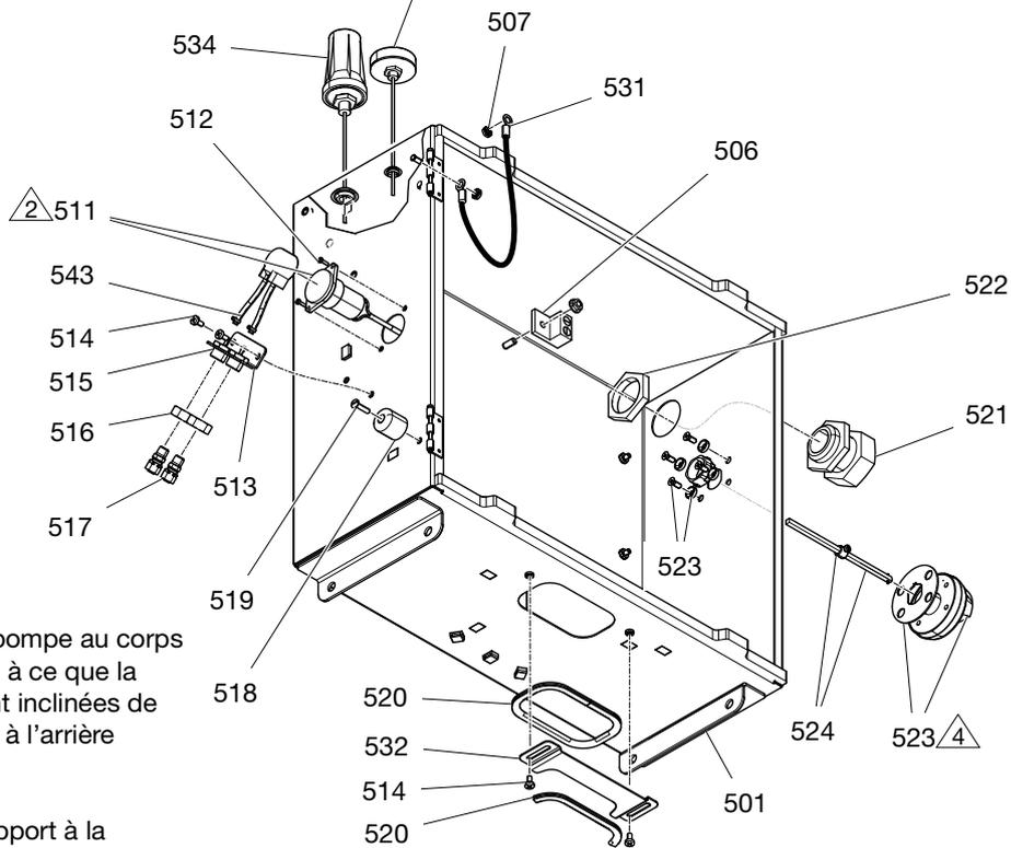
2 Assembler la tête de pompe au corps de pompe de manière à ce que la sortie et l'entrée soient inclinées de 45 degrés par rapport à l'arrière du boîtier.
