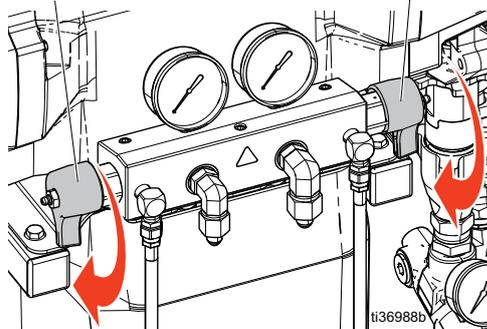
4. utiliser le mode jog (à-coups) pour faire circuler le fluide. Les systèmes Reactor permettent de mettre en mode Jog l'ensemble du système ou
