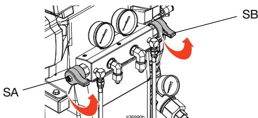
11. Engager le verrouillage de sécurité du pistolet, puis fermer les vannes A et B du collecteur de fluide.
