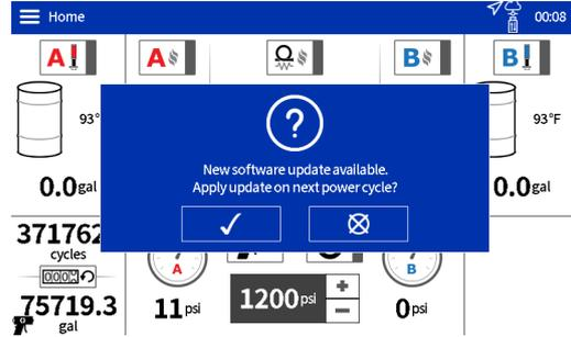
5. Pulse en la marca de verificación y espere el mensaje en pantalla para preparar el Reactor para actualizar en el siguiente ciclo de apagado y encendido.
