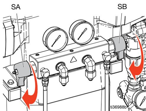
4. 使用慢送模式循环流体。Reactor 系统允许整个系统处于慢送模式，或者 A 和 B 侧输送泵分别进入慢送模式。请参考操作手册中的慢送模式说明。循环流体，直到只有溶剂来自排料管线。Reactor 进料软管、泵和加热器现在已冲洗完成。
