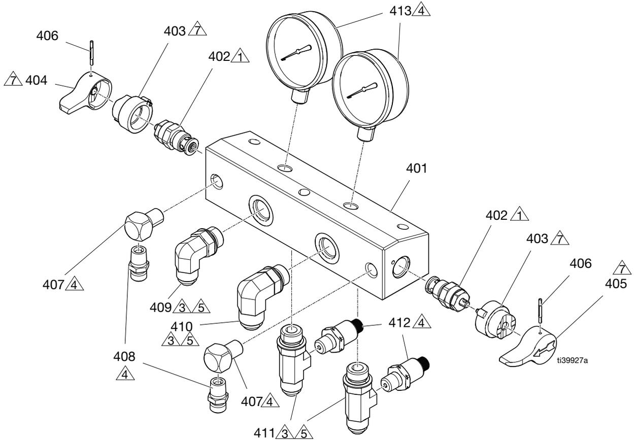
1 在螺纹上涂抹密封剂并用 250 +/- 10 in-lb (28 +/- 1.1 N•m) 的扭力拧紧。
