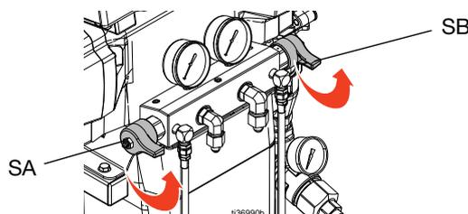
11. 确保锁上喷枪保险栓，然后关闭流体歧管阀 A 和 B。
