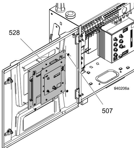
5. 连接 CAN 电缆和蜂窝模块电缆。请参见**电气示意图**，第 69 页。
