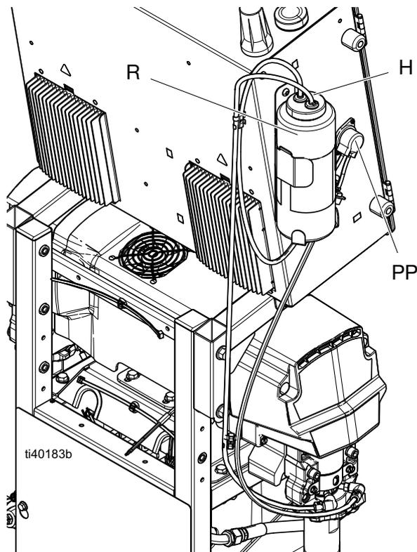
7. 通过在配比泵正常操作期间感觉回流软管的脉动情况，确认 TSL 液泵正在正常运行。
