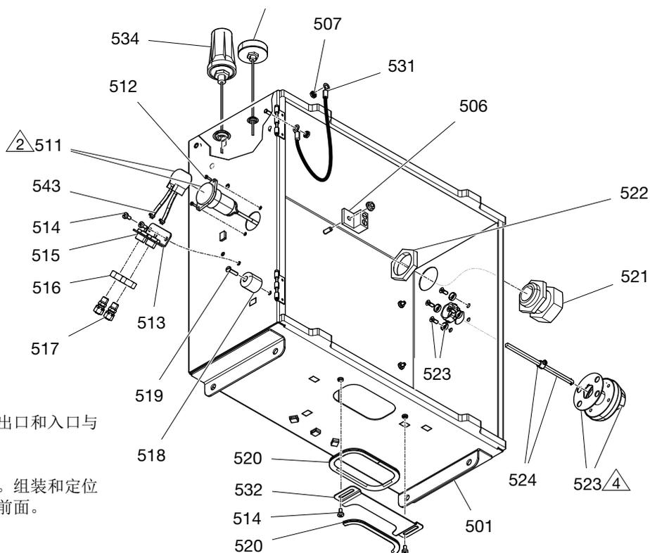
2 将泵头组装到泵体上，使出口和入口与外壳后部成 45 度角。
