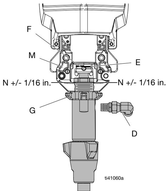
2. 继续将泵拧入轴承套，直到流体出口 (D) 与钢管对齐而且顶部螺纹距离轴承面 (N) 上下  $1/16 \text{ in.}$  (2 mm)。
