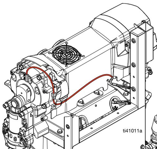
3. 将马达板放在框架 (1) 上并部分用手拧紧所有螺栓 (22)。套好所有螺栓并对齐马达板后，拧紧螺栓 (22)。
