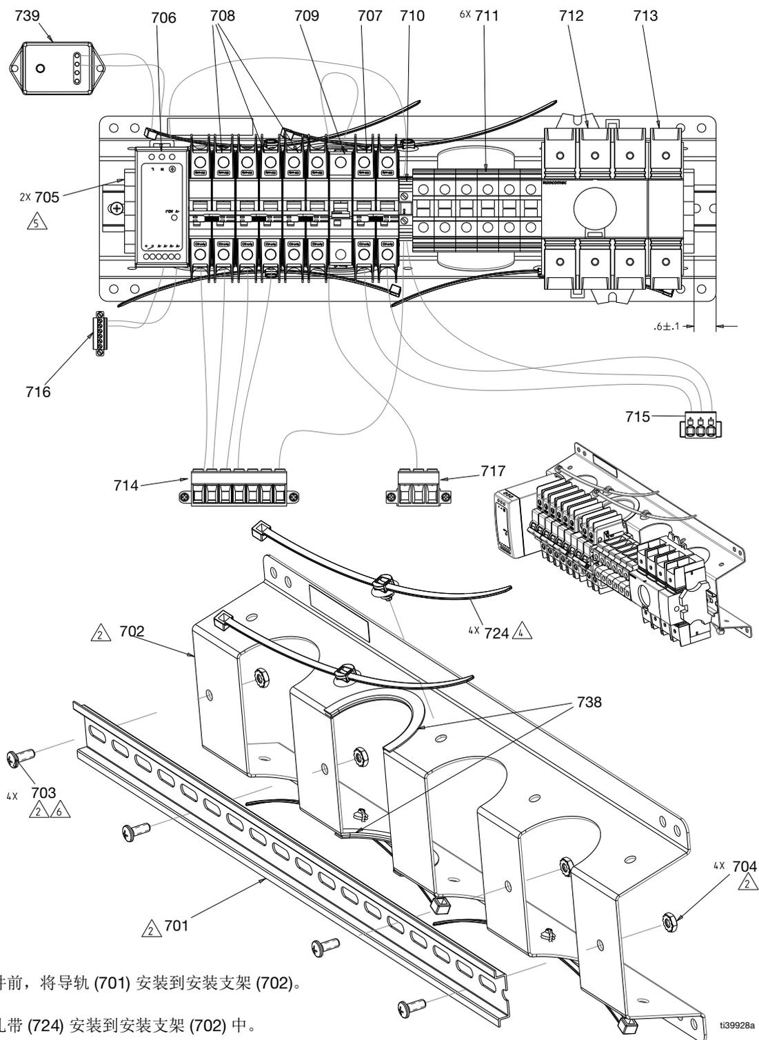
2 安装组件前，将导轨 (701) 安装到安装支架 (702)。
